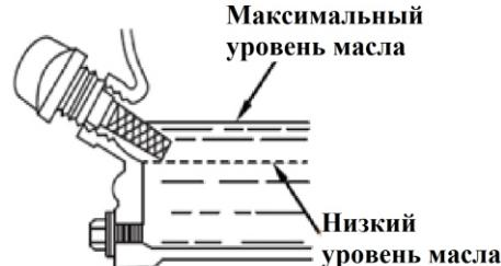
максимального уровня. После заливки масла не забудьте закрутить измеритель уровня масла. Если уровень масла ниже предельного уровня, система защиты масла остановит двигатель. Поэтому, чтобы избежать этой проблемы, пожалуйста, проверяйте уровень масла перед каждым запуском.
